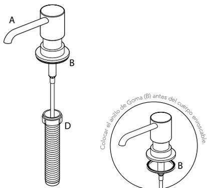
2. Instalar el ensamble del cuerpo (A) ya unido al cuerpo enroscable (D) y el anillo de goma (B) en el orificio pretaladrado en la encimera. Enroscar la tuerca de montaje (C) y ajustar hasta que se sienta firme el dispensador.
