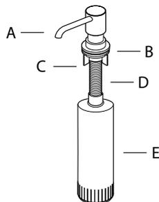
1. Unir el cuerpo enroscable (D) y el anillo de goma (B) al ensamble del cuerpo (A). Ajustar lo necesario.
