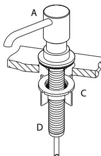
3. Una vez ajustado la tuerca de montaje (C), coloque la botella (E).
